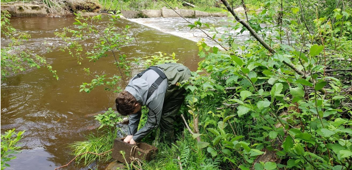
Figure 4: Installation de l'enregistreurs de données pour la température de l'eau dans la rivière Kouchibouguac en juin 2023.
